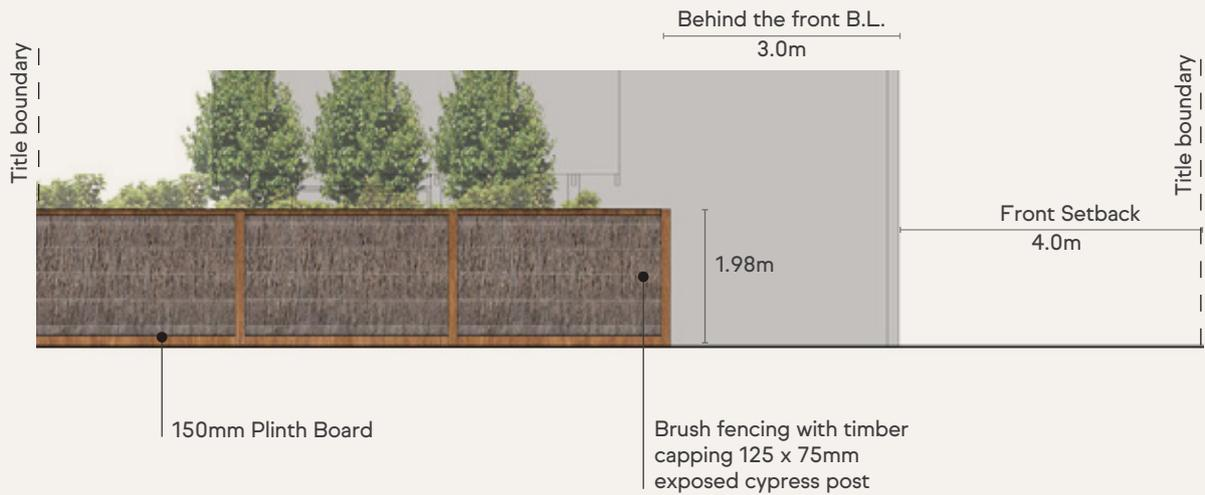
**DIAGRAM 10 – TYPE C: SMALL LOT HOUSING CODE (SLHC) FENCING**
